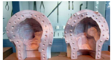
Moule à bon creux à pièces
